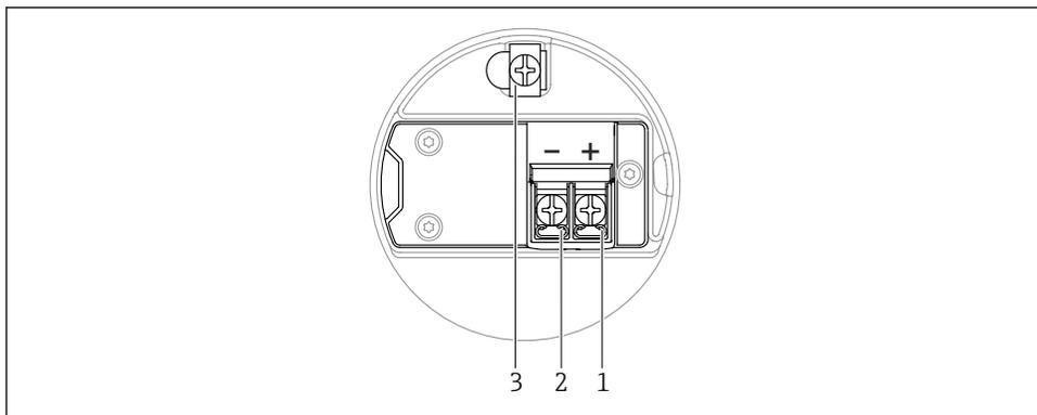
2 Os terminais de conexão e os terminais de terra no compartimento de conexão
