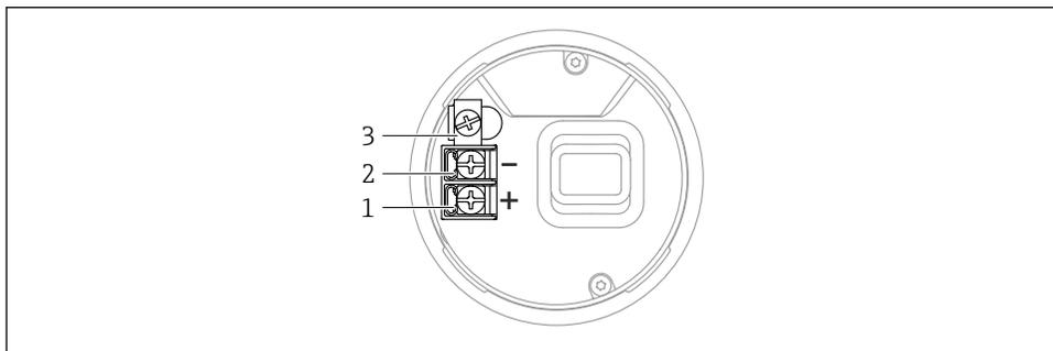
1 Os terminais de conexão e os terminais de terra no compartimento de conexão
