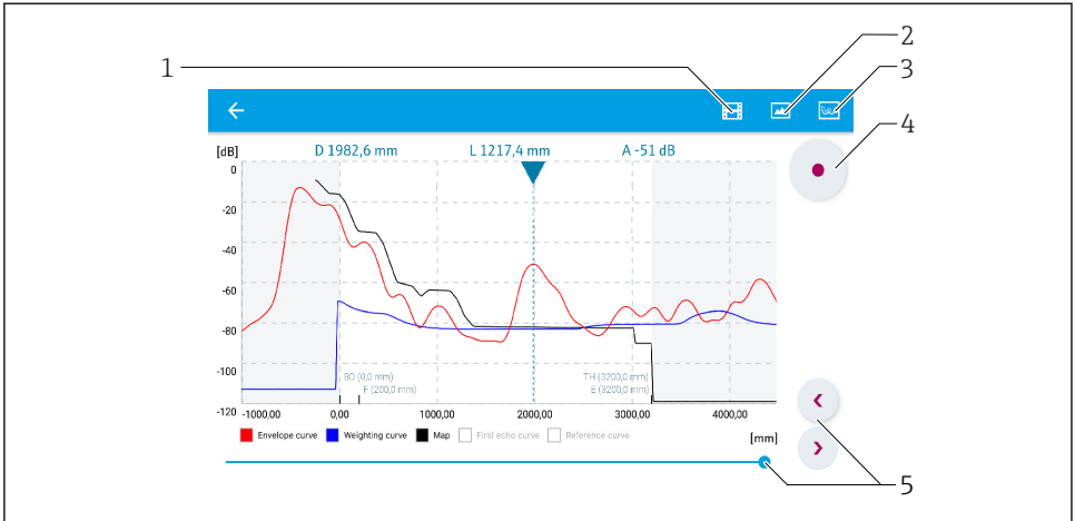
24 Hüllkurvendarstellung (Beispiel) in SmartBlue bei Android
