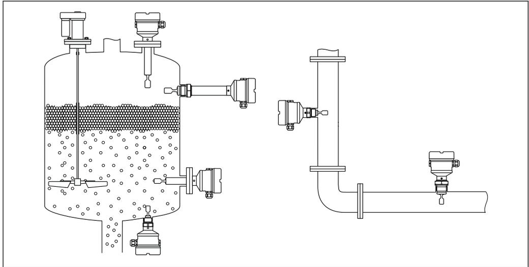
图 3 安装实例: 安装在容器、罐体或管道中
