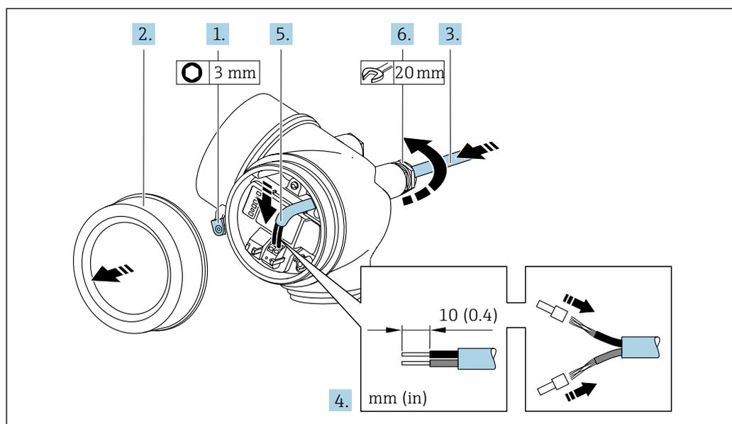
1. Ослабьте фиксирующий зажим крышки клеммного отсека.
