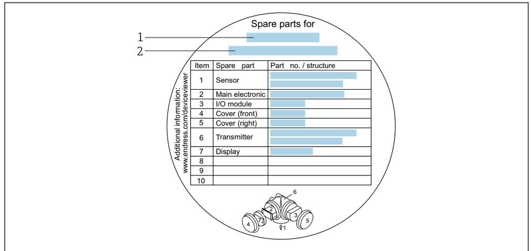
26 Пример ярлыка с обзором запасных частей на крышке клеммного отсека
