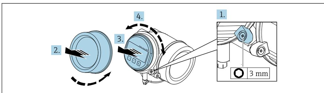
1. Ослабьте фиксирующий зажим крышки отсека электронного модуля с помощью шестигранного ключа.
