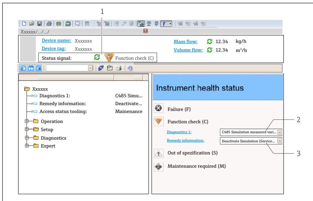
1 Область состояния с сигналом состояния → 154
