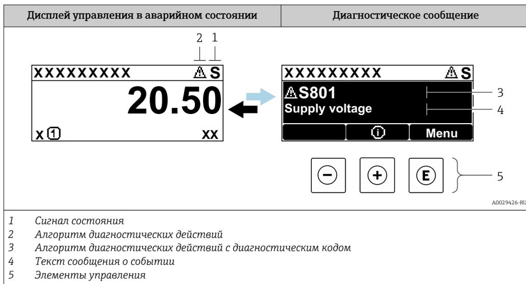
Если в очереди на отображение одновременно присутствуют два или более диагностических события, то выводится только сообщение о диагностическом событии с наивысшим приоритетом.
