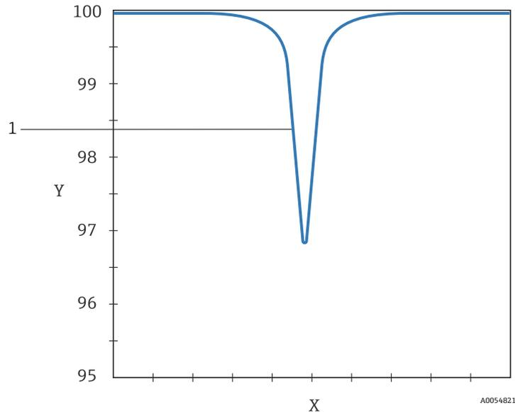
Abbildung 2. Typisches normalisiertes Absorptionssignal von einem Laserdioden-Absorptionsspektrometer
