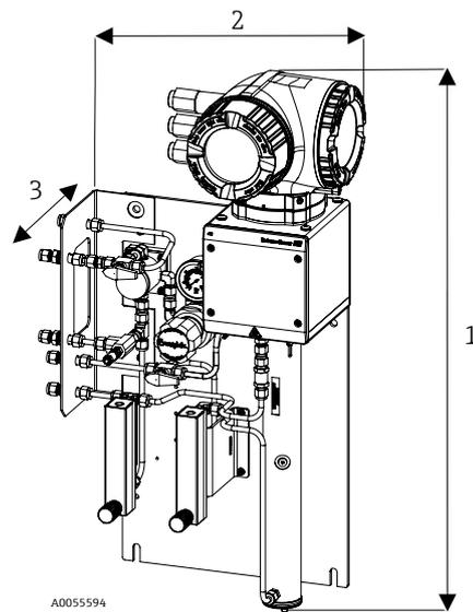
Abbildung 11. J22 TDLAS-Gasanalysator mit SCS auf Analysetafel
