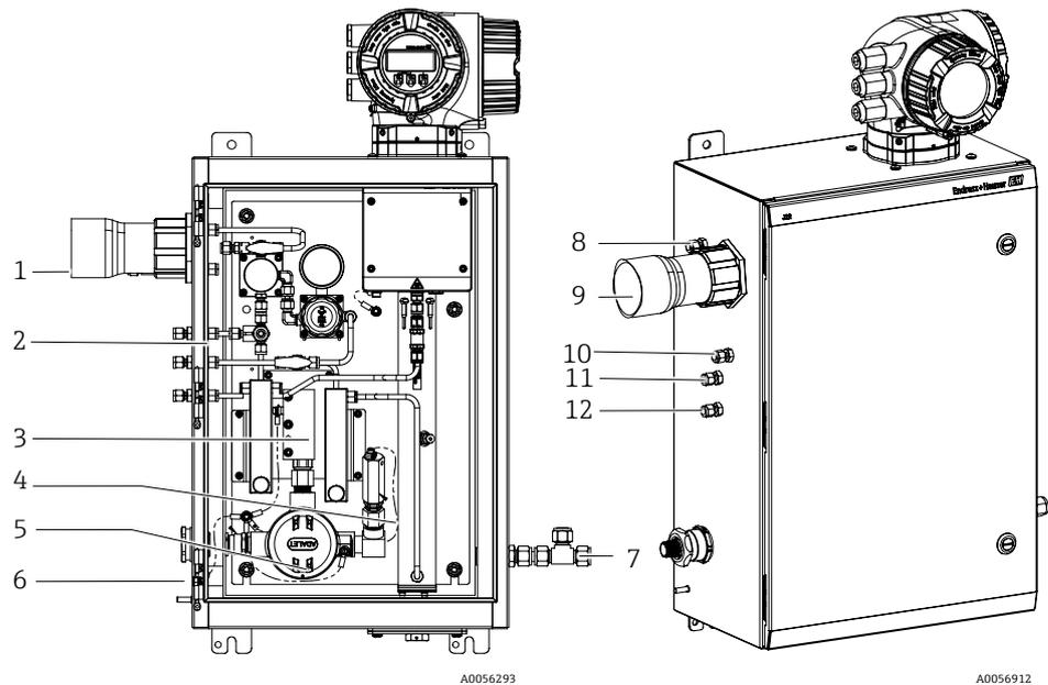
Abbildung 6. J22 TDLAS-Gasanalysator mit SCS im Gehäuse – Probenentnahmesystem und Gasanschlüsse
