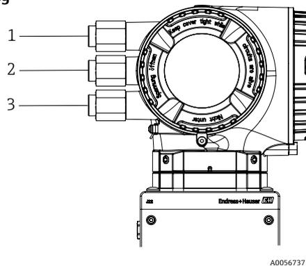
Abbildung 14. Anschlüsse der Steuerung für den J22 TDLAS-Gasanalysator
