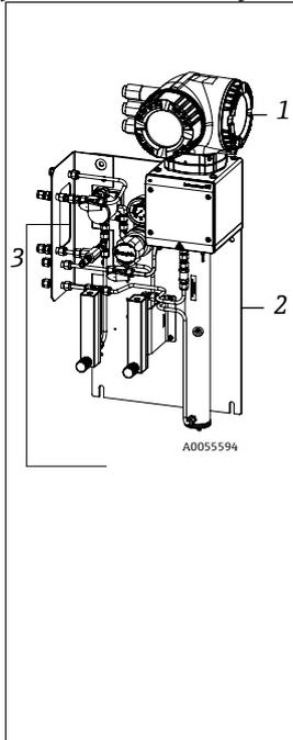
Das Analysatorsystem auf einer Analysetafel umfasst die folgenden Komponenten und ist für die Montage in Außenbereichen in der Nähe des Probenentnahmepunkts oder für die Montage innerhalb eines Schutzgehäuses ausgelegt.
