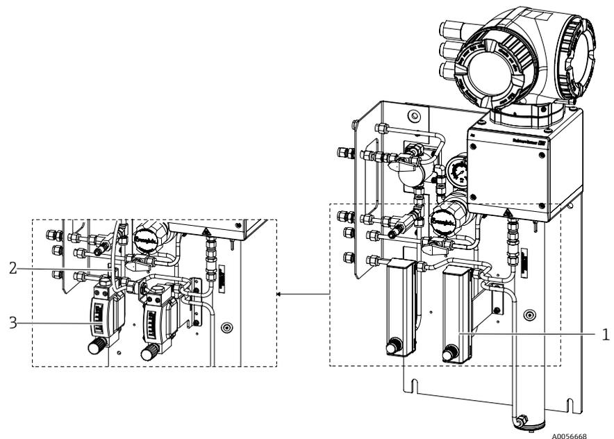
Abbildung 5. J22 TDLAS-Gasanalysator auf Analysetafel, mit Durchflussmessgerät-Optionen (2)
