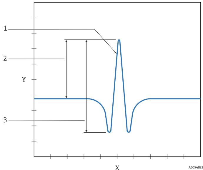
Abbildung 3. Einfaches normalisiertes  $2f$ -Signal; Analytkonzentration proportional zur Peak-Höhe oder Peak-to-Peak-Höhe, abhängig vom verwendeten Algorithmus
