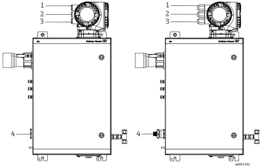
Abbildung 13. Schraubeinführungen für J22-Gehäuse für ATEX- (links) und zöllige (rechts) Anschlüsse
