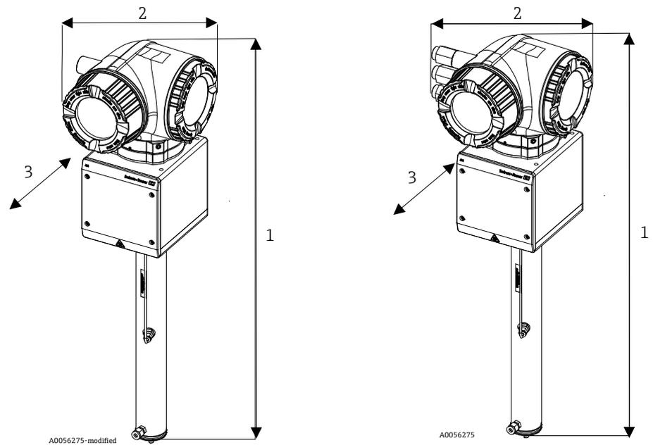
Abbildung 10. J22 TDLAS-Gasanalysator, ATEX-Konfiguration (links) und CSA-Konfiguration (rechts)
