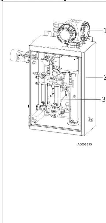
Das Analysatorsystem im Gehäuse und mit optionalem Heizer besteht aus folgenden Komponenten und wird typischerweise zur Montage im Freien, in der Nähe des Probenentnahmepunkts, verwendet.
