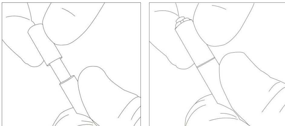
Рис. 28. Установка влагопоглотителя в чехол
