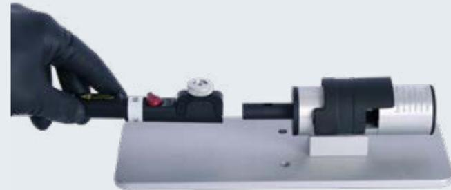
Anschluss der Raman-Rxn-10-Sonde an die Micro Flow Bench
