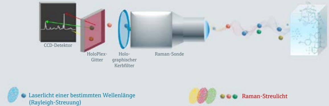
Das gesammelte Licht wird von der Kamera als Spektrum interpretiert und erzeugt einen „molekularen Fingerabdruck“ des untersuchten Materials.
