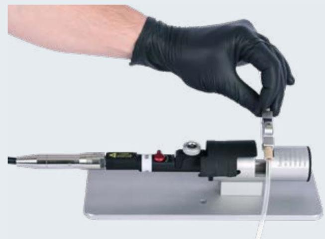
Einsetzen der Micro Flow Cell in die Micro Flow Bench
