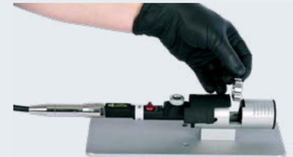
Einsetzen einer Verifizierungszelle in eine Micro Flow Bench, die mit einer Rxn-10-Sonde verbunden ist
