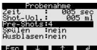
Abb. 15: Probenahme Funktion "Pre-Shots" ASP Inline (über Steuerung ASP Station 2000)
