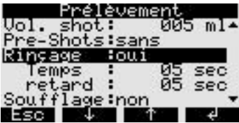
Fig. 16 : Fonction de prélèvement "Rinçage" ASP Inline (via l'unité de commande ASP Station 2000)
