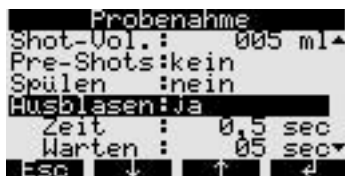
Abb. 17: Probenahme Funktion "Ausblasen" ASP Inline (über Steuerung ASP Station 2000)
