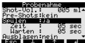
Abb. 16: Probenahme Funktion "Spülen" ASP Inline (über Steuerung ASP Station 2000)
