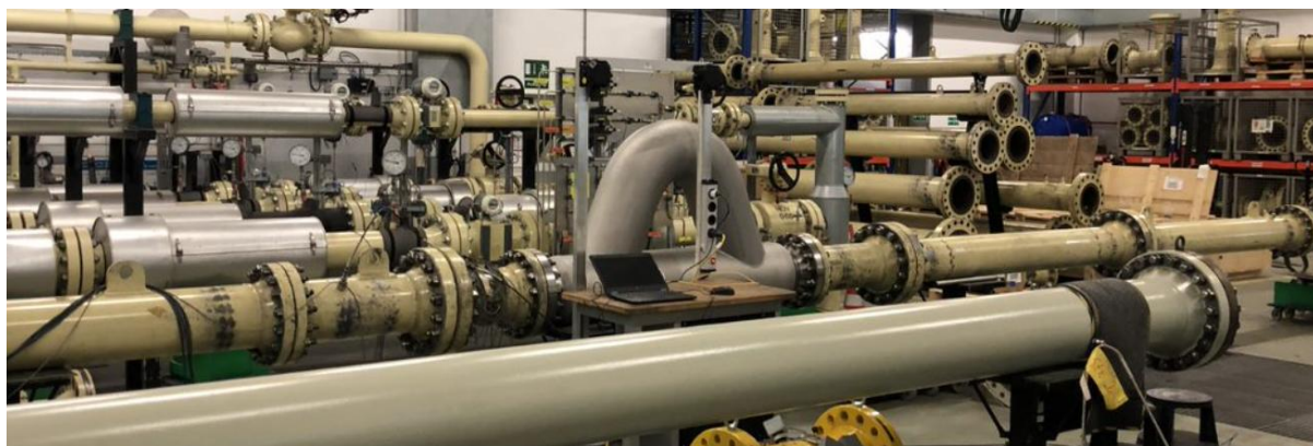
図 3 : Pigsar 設備で、校正用流体として天然ガスを使用して校正されている Proline Promass Q 呼び口径 200A
