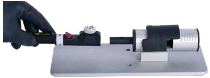
Verbinden von Rxn-10-Sonde und Micro Flow Bench
