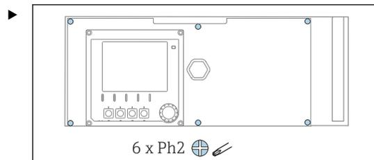
プラスドライバーを使用して、電子部カバーの 6 本のネジを緩め、カバーを正面方向に傾けます。
