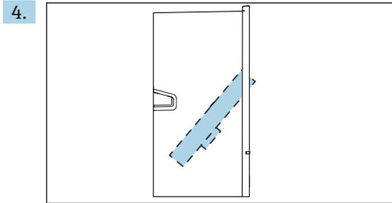
キャリアプレートを正面方向に傾けて取り外します。
