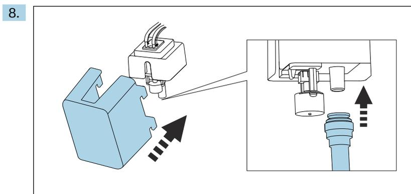
再び流出口用ホース「W」を接続し、カバーを固定します。
