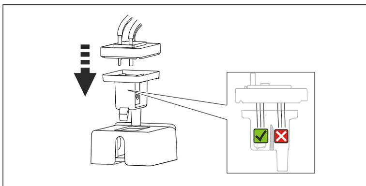
ゴム製カバーをキュベットの元の位置に取り付け、すべてのキャピラリが測定チャンバに配置されていることを確認します。
