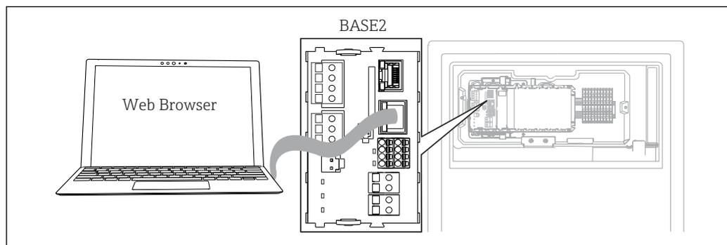
図 55 Web サーバー/Ethernet 接続
