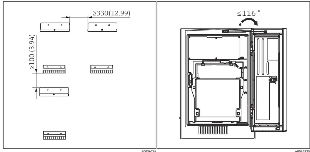
図 18 取付けに必要な最小間隔。測定単位 mm (in) 図 19 最大開放角度
