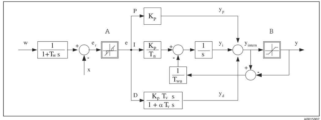
図 73 コントローラ構造のブロック図
