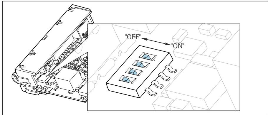
図 50 内部終端処理用の DIP スイッチ
