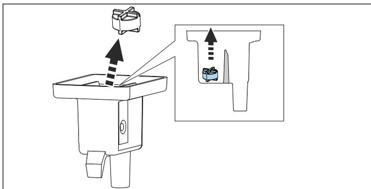
磁気スターバーを測定チャンバから取り外します。
