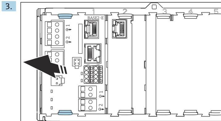
ベースモジュールの固定クリップを同時に押して、ベースモジュールを引き抜きます。
