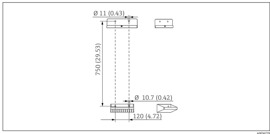
図 20 ホルダの寸法。測定単位 mm (in)
