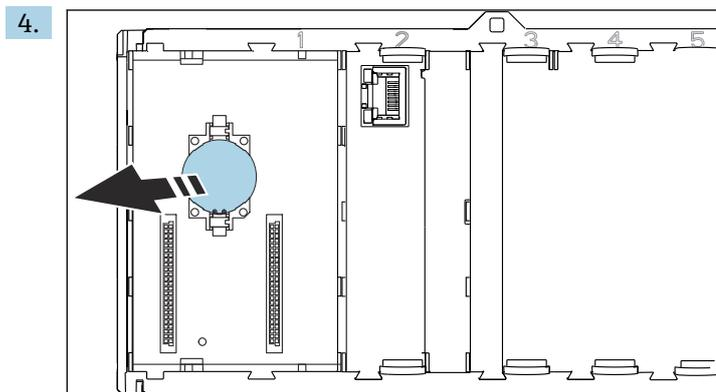
リチウムボタン電池をバックプレーンから取り外し、バッテリーに関する地域の規制に従って廃棄します。
