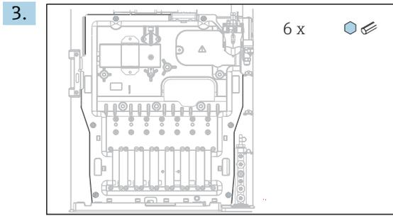
Torx ドライバ (T25) を使用してキャリアプレートのネジ 6 本を緩めます。
