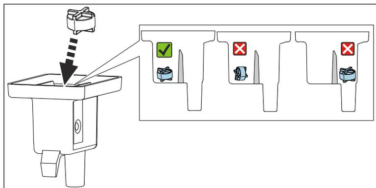
磁気スターバーを測定チャンバに配置し、測定チャンバ内で水平になっていることを確認します。
