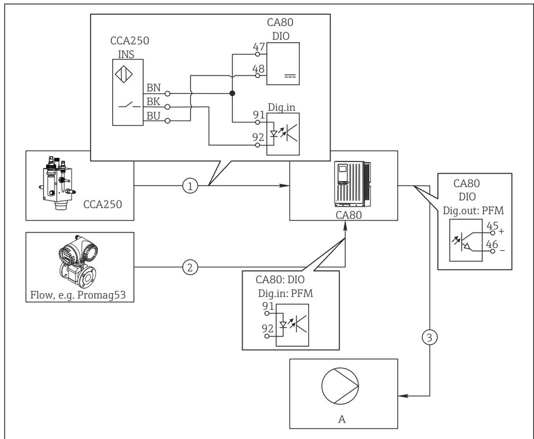
図 63 フィードフォワード制御による塩素制御の例
