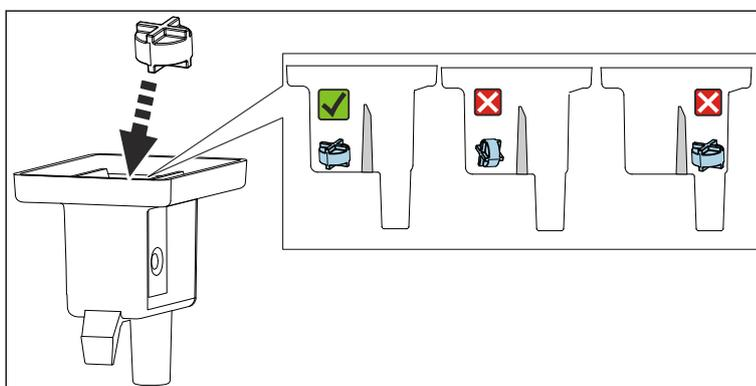
磁気スターバーを測定チャンバに戻し、測定チャンバ内で水平になっていることを確認します。
