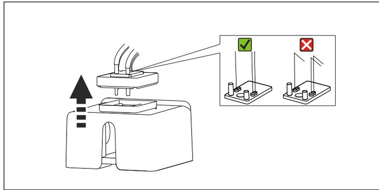
キュベットのゴム製カバーを持ち上げて取り外します。キャピラリホルダまたはバルブのキャピラリにねじれがないことを確認します。キャピラリをホースコネクタから取り外さないでください。
