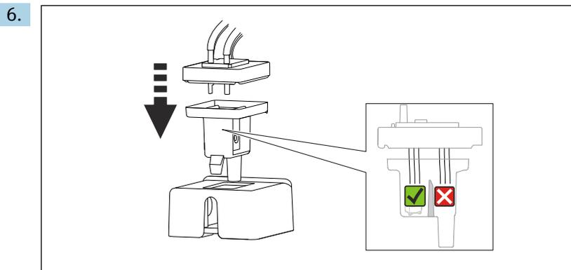
ゴム製カバーを元の位置に取り付け、すべてのキャピラリが測定チャンバに配置されていることを確認します。
