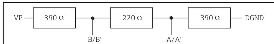
図 51 内部終端の構造
