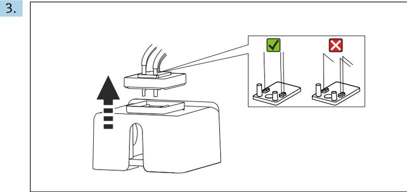
キュベットのゴム製カバーを持ち上げて取り外します。キャピラリホルダまたはバルブのキャピラリにねじれがないことを確認します。キャピラリをホースコネクタから取り外さないでください。
