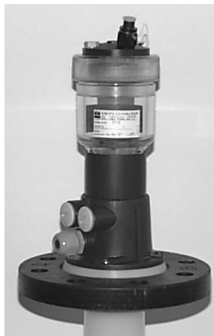
Réservoir de KCl monté sur la sonde CPA 140
