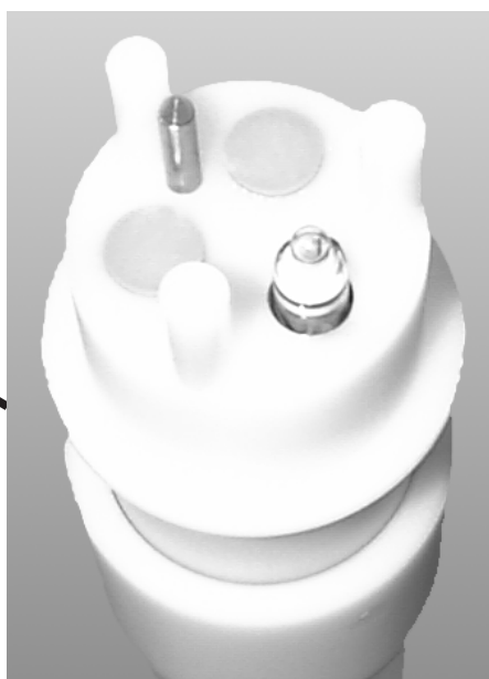
Vue de dessous du porte-électrode avec une électrode montée et la broche de compensation de poten-
