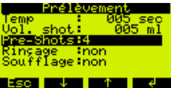
Fig. 15 : Fonction de prélèvement "Pre-shots" ASP Inline (via l'unité de commande ASP Station 2000)
