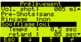
Fig. 17: Fonction de prélèvement "Soufflage" ASP Inline (via l'unité de commande ASP Station 2000)
