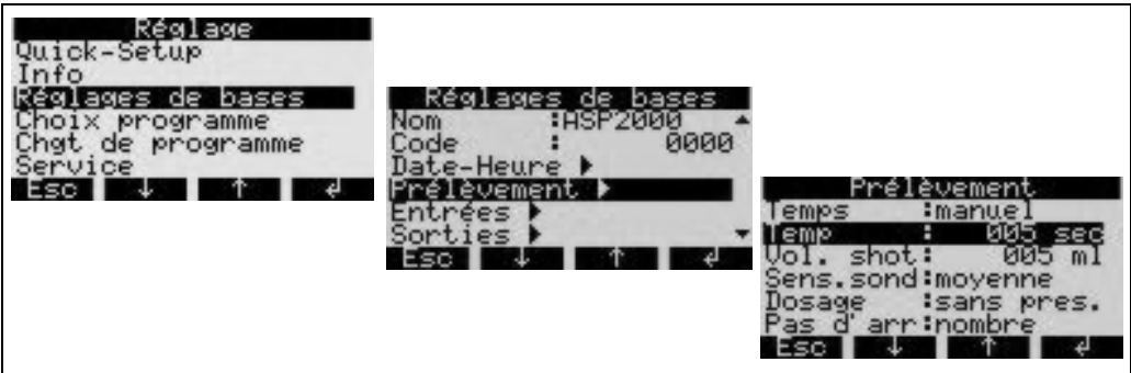
Fig. 14 : Structure de menus prélèvement ASP Inline (via l'unité de commande ASP Station 2000)
