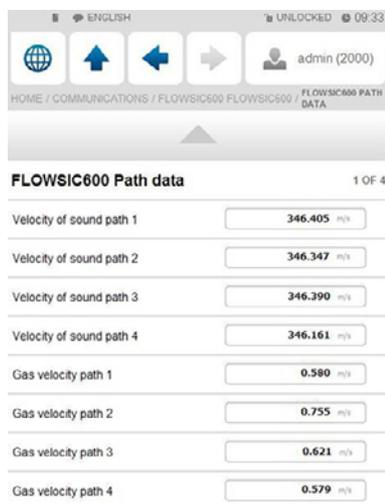
Fig. 31 - Voce di menu Communication -> Flowsic600-XT Flow Meter -> Flowsic600-XT Path Data
