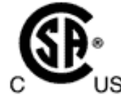
Figura 5. Etiqueta que indica que el equipo está homologado para el uso en zonas con peligro de explosión en Estados Unidos y en Canadá
