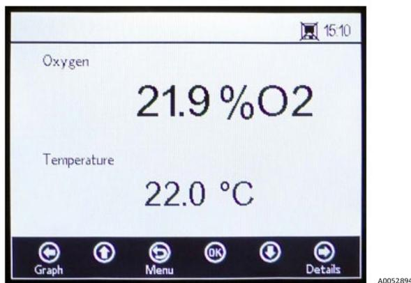
Figure 26. Écran de mesure SIMPLE
