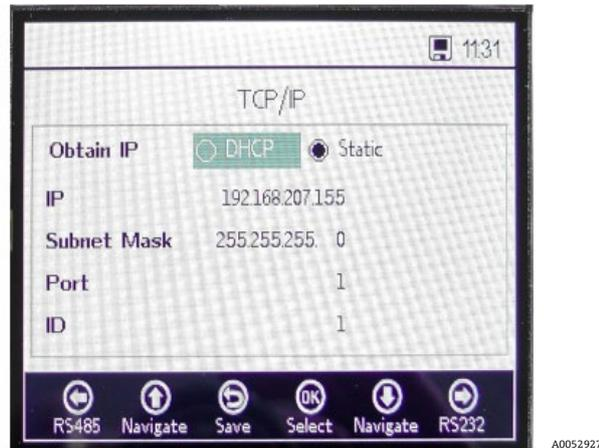
Figure 63. Écran "Digitals" – Paramètres TCP/IP
