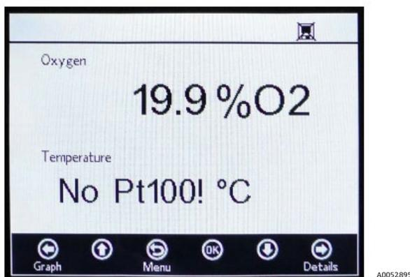
Figure 27. Message d'erreur du capteur de température
