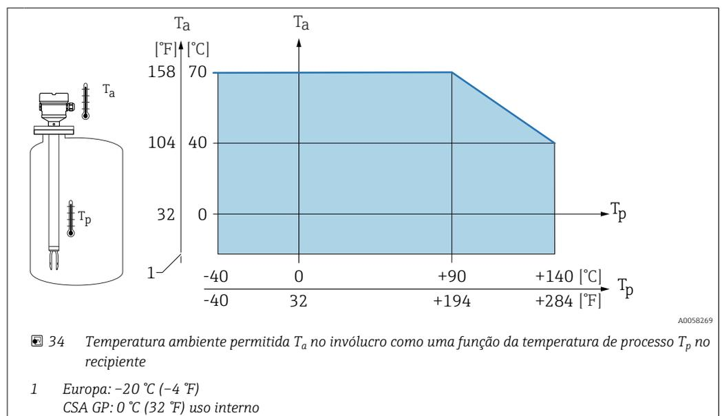
**Invólucro do compartimento único (alumínio, revestido) e invólucro do compartimento duplo (alumínio, revestido e 316L)**
