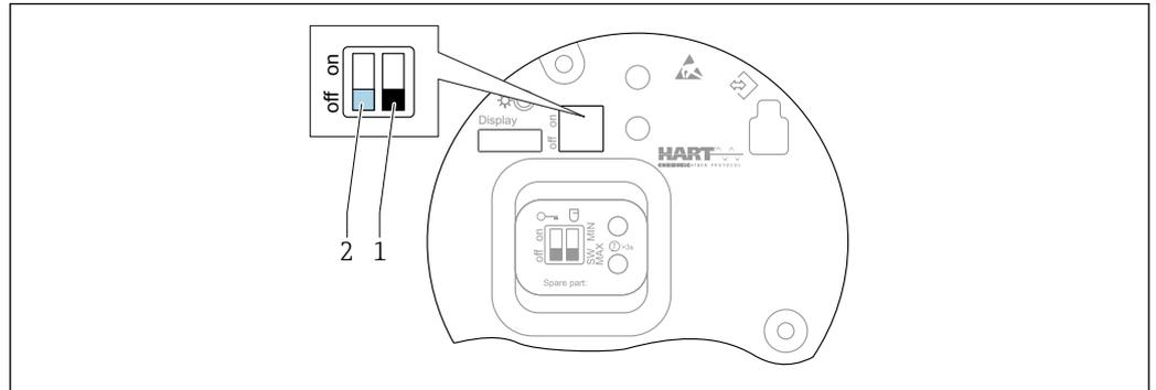
Fig. 27 Funções das minisseletoras na unidade eletrônica FEL60H
