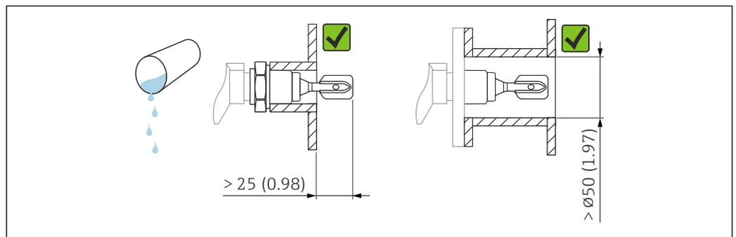
5 Exemplo de instalação para líquidos de baixa viscosidade. Unidade de medida mm (in)
