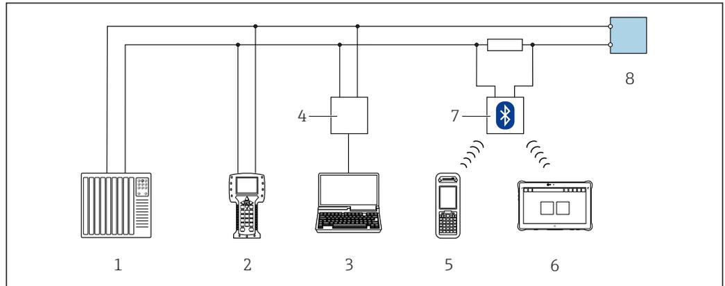
34 Opzioni per funzionamento a distanza mediante protocollo HART (attivo)
