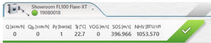
Die Einheit für den Heizwert in FLOWgate™ kann angepasst werden.
