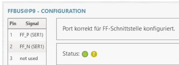
Um Werte aus dem Gerät zu lesen, ist die FF-bezogene Konfiguration erforderlich, z. B. Knotenadresse und Kommunikationsbeziehung der FF-Blöcke. Diese FF-Konfiguration ist nur über den Feldbus zugänglich, nicht über die FLOWgate™ Bediensoftware.
