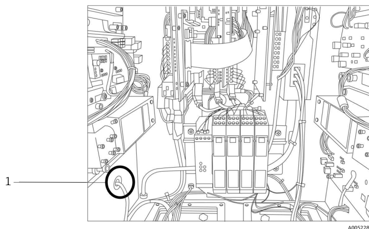
Figura 12. Sensor de temperatura externo (1) instalado na parte inferior da câmara esquerda
