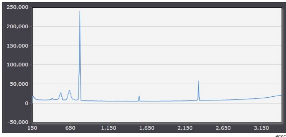
Figura 39. Espectro típico de um analisador Raman Rxn5
