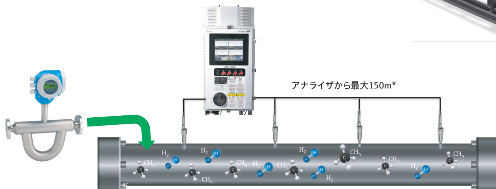
図8: 長いパイプラインに複数のラマンプローブを使用することで、注入後に水素がどのように流れに混合されるかを特定するのに役立ちます。
