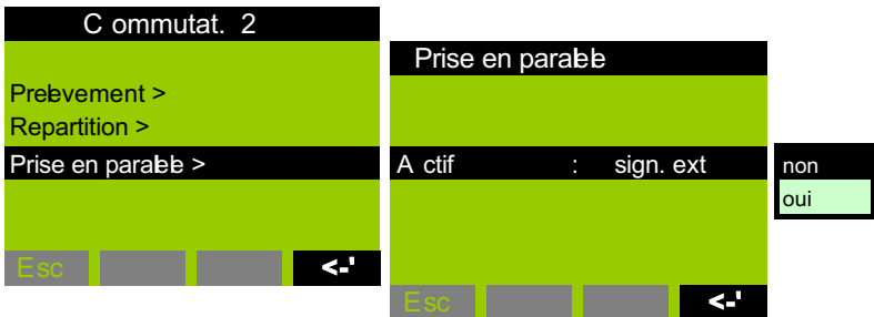
Fig. 45: Structure du menu Activation de la prise en parallèle
