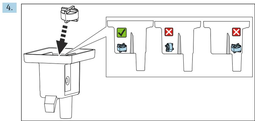
Coloque a barra de agitação magnética de volta na câmara de medição, certificando-se de que esteja nivelada e dentro da câmara de medição.
