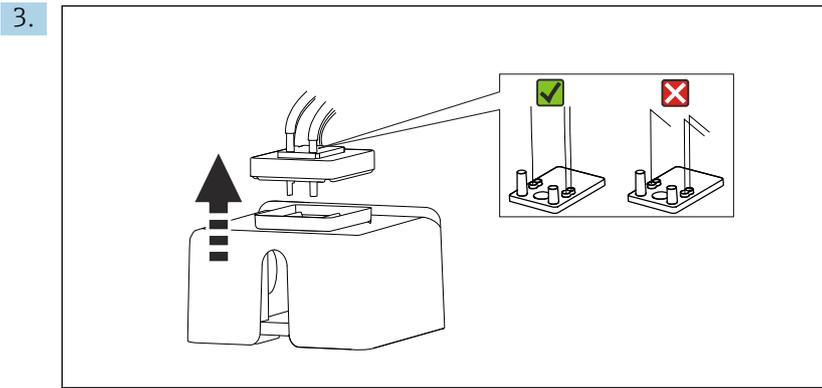
Eleve a tampa de borracha da cuveta. Não deve haver dobras nos capilares no porta-capilar ou nas válvulas e os capilares não devem ser removidos da mangueira do conector.
