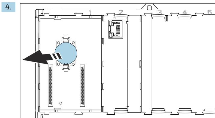
Remova a célula de lítio tipo botão do painel traseiro e descarte-a de acordo com os regulamentos locais sobre baterias.
