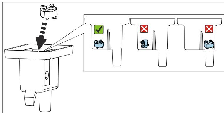
Coloque a barra magnética de mistura na câmara de medição, certificando-se de que ela esteja nivelada e dentro da câmara de medição.
