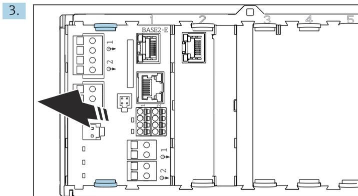
Comprima os grampos de fixação do módulo base e puxe-os para fora do módulo base.
