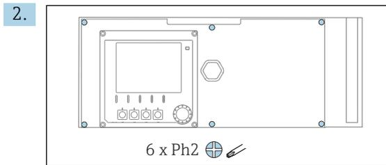
Solte os seis parafusos na tampa do compartimento dos componentes eletrônicos usando uma chave Phillips e dobre a tampa para a frente.
