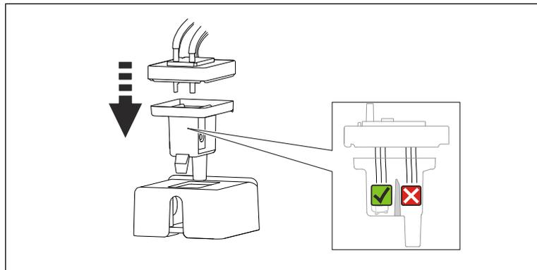
Coloque a tampa de borracha de volta, certificando-se de que todos os capilares estejam localizados na câmara de medição.
