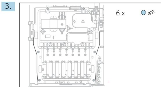
Solte os 6 parafusos na placa da portadora usando uma chave de fenda Torx (T25).
