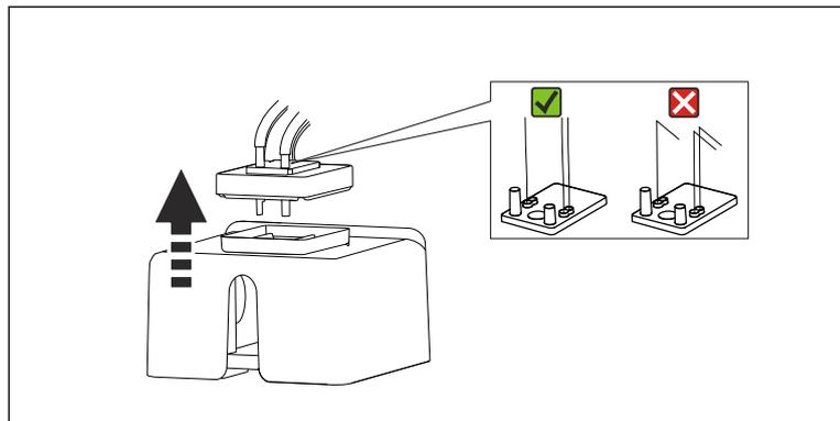
Eleve a tampa de borracha da cuveta. Não deve haver dobras nos capilares no porta-capilar ou nas válvulas e os capilares não devem ser removidos da mangueira do conector.
