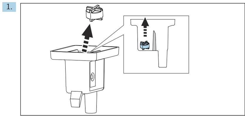
Remova a barra magnética de mistura da câmara de medição.
