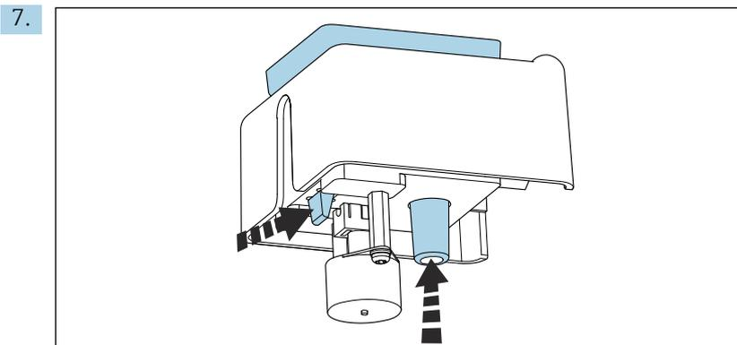
Empurre a cuveta por baixo pressionando simultaneamente a aba e o encaixe da mangueira.
