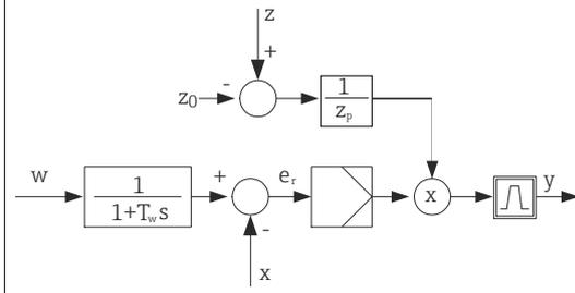
Estritamente falando, o controle feedforward envolve um sistema de controle de ciclo aberto, já que seu efeito não é medido diretamente. Isto significa que a vazão de alimentação é direcionada exclusivamente para frente. Por isso a designação "controle feedforward".
