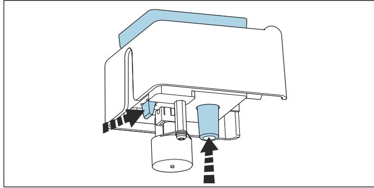
Empurre a cubeta para fora por baixo pressionando simultaneamente contra a aba e a fixação da mangueira.
