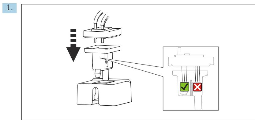
Coloque a tampa de borracha na cuveta, e certifique-se de que todos os capilares estejam na câmara de medição.
