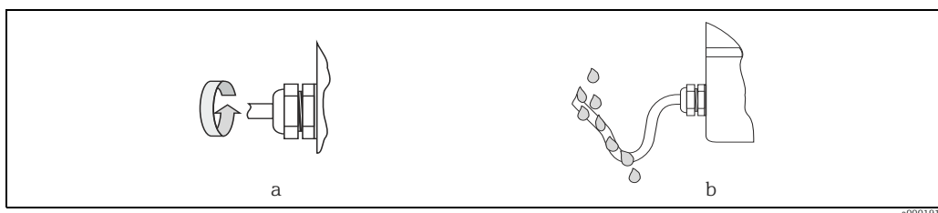
Abb. 37: Montagehinweise für Kabeleinführungen
