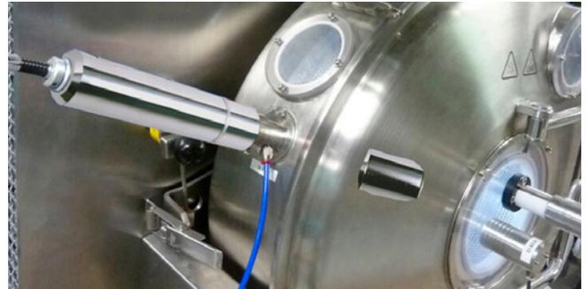
Raman-Rxn-20-Sonde zur Beschichtungsanalyse
