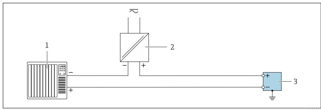
■ 12 Anschlussbeispiel für Impuls-/Frequenz-/Schaltausgang (passiv)
