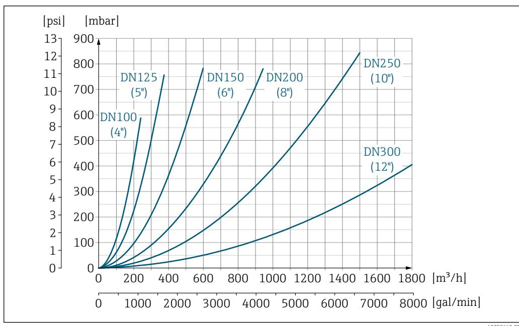
图 33 Druckverlust DN 100 ... 300 (4 ... 12") bei Bestellmerkmal "Bauart", Option C "Festflansch, Messrohr eingeschnürt, 0 x DN Ein-/Auslaufstrecken"
