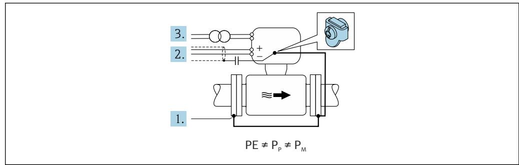
1. Rohrleitungsflansche und Messumformer über Erdungskabel verbinden.
