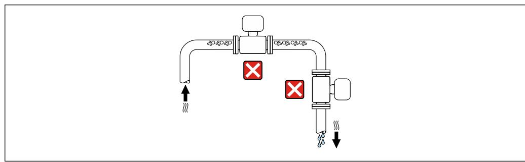
Der Einbau des Geräts in eine Steigleitung ist zu bevorzugen.
