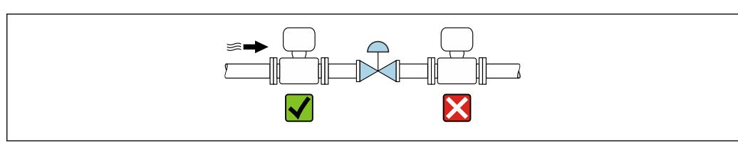
*Einbau vor einer Fallleitung***HINWEIS****Unterdruck im Messrohr kann die Messrohrauskleidung beschädigen!**
