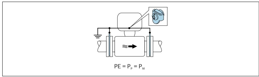
1. Erdungsscheiben über das Erdungskabel mit der Erdungsklemme von Anschlussgehäuse von Messumformer oder Messaufnehmer verbinden.
