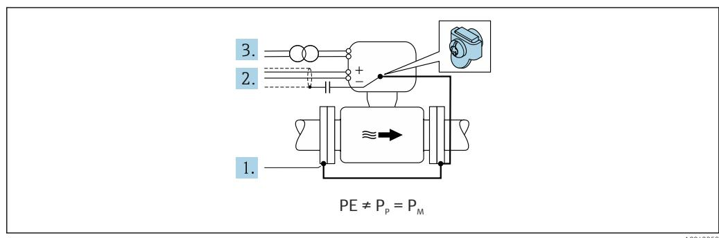
1. Rohrleitungsflansche und Messumformer über Erdungskabel verbinden.
