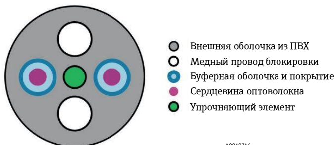
Рисунок 1. Изображение поперечного сечения оптоволоконного кабеля Raman
