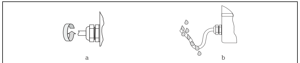
Abb. 42: Montagehinweise für Kabeleinführungen
