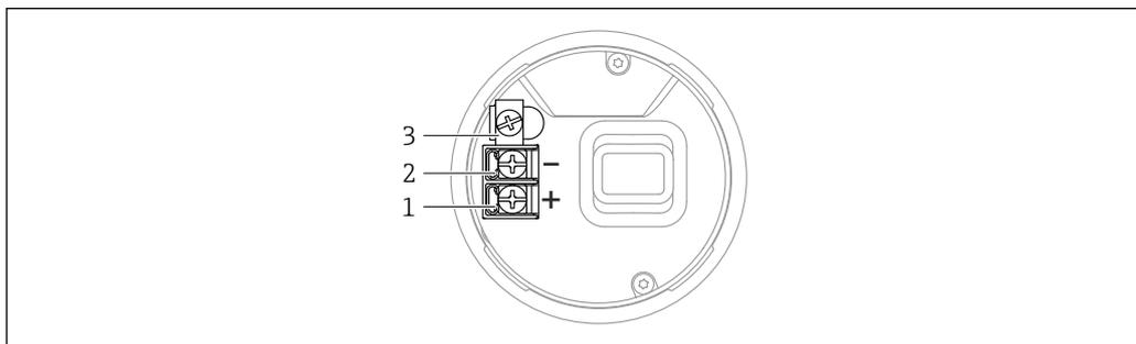
図 1 端子部の接続端子と接地端子
