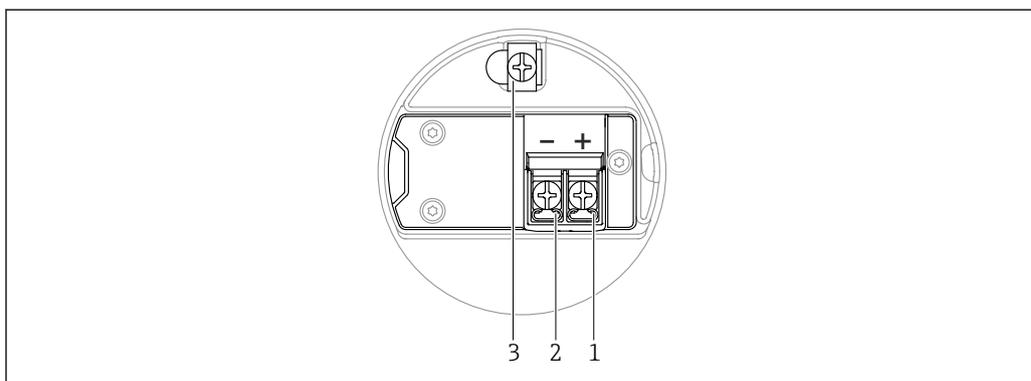
図 2 端子部の接続端子と接地端子
