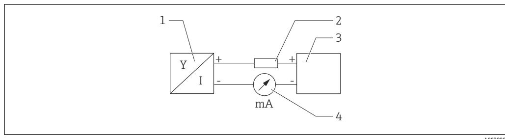
图 17 HART 信号回路连接框图
