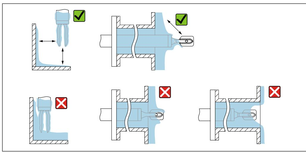
图 8 安装实例：测量高粘度过程介质
