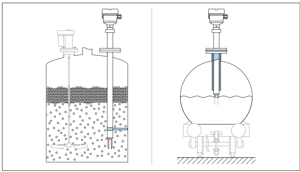
图 10 实例：存在动态负载时，应支撑设备
