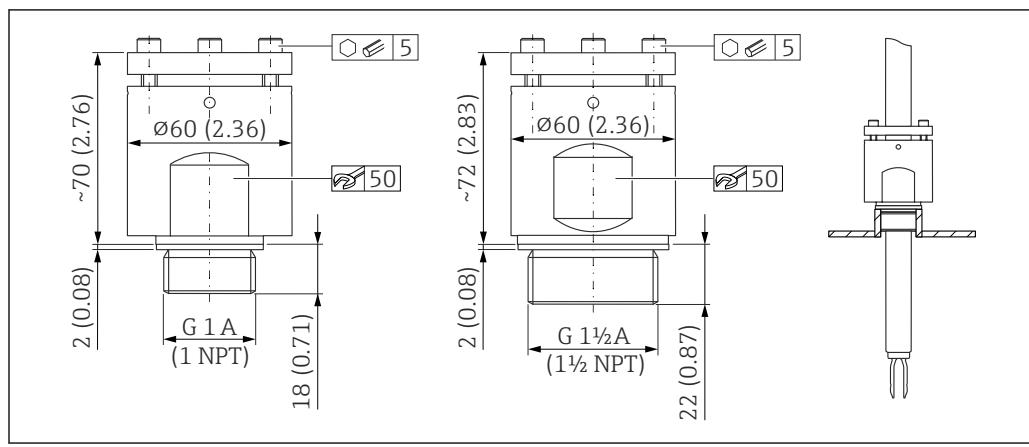
32 高压滑动套管。测量单位 mm (in)
