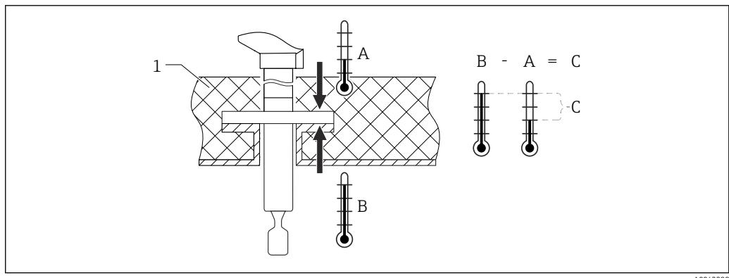
图 4 法兰外侧和内侧间的温差
