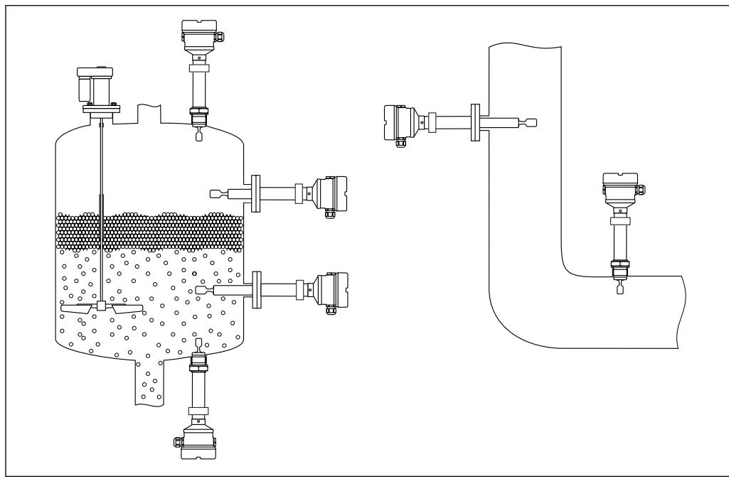
图 3 安装实例：安装在容器、罐体或管道中
