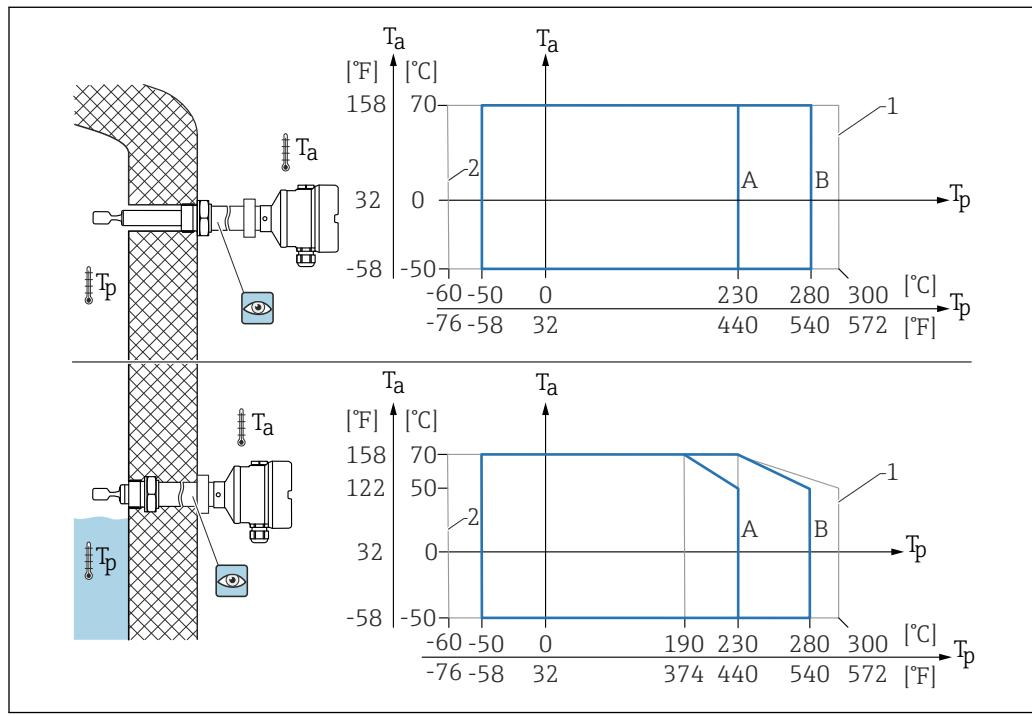
图 33 外壳允许环境温度  $T_a$  与罐体内部过程温度  $T_p$  的关系
