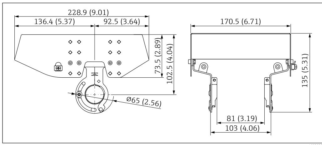
图 29 双腔体铝外壳的防护罩。测量单位 mm (in)
