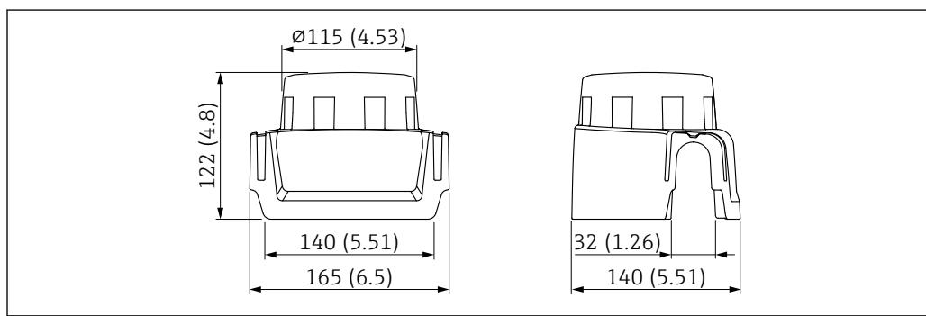
图 30 保护盖, 适用单腔体铝外壳或 316L 外壳。测量单位 mm (in)
