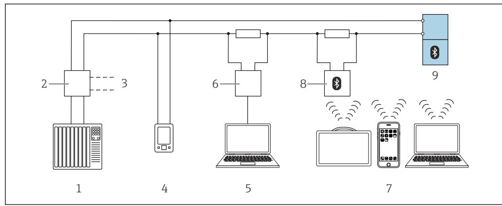
图 25 通过 HART 通信实现远程操作
