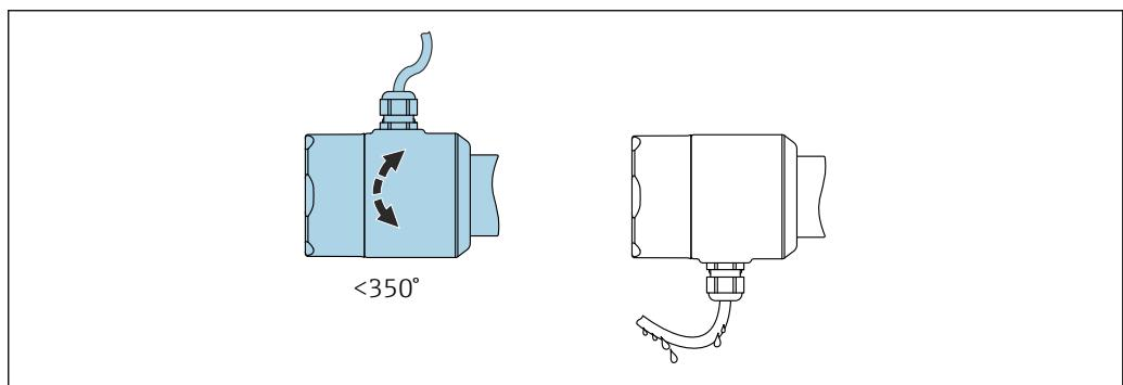
图 14 外壳不带锁紧螺丝, 带排水回路
