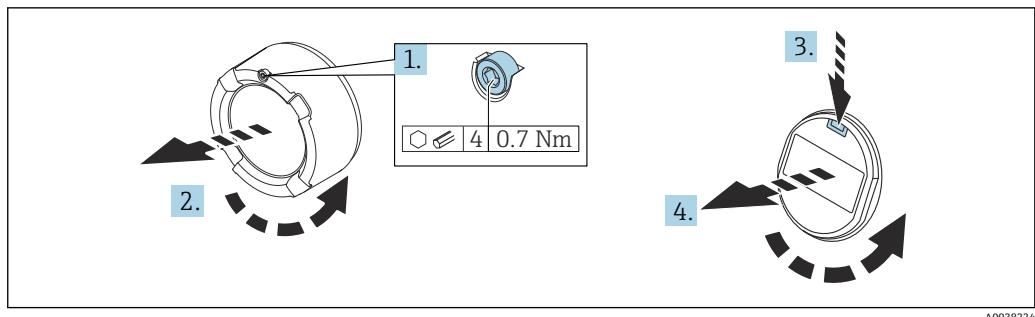
1. 如果已安装电子腔盖：使用内六角扳手松开电子腔盖锁扣螺丝。
