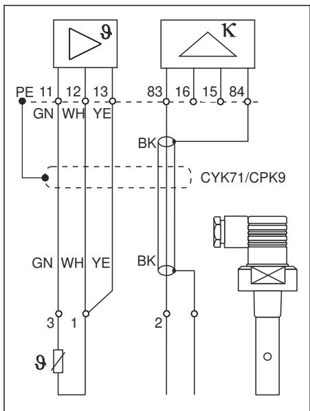
7 Подключение кондуктивных датчиков
