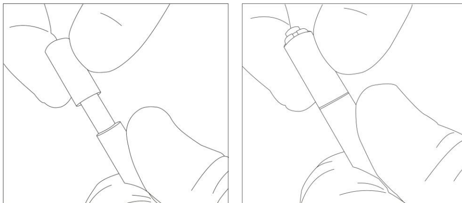
Figura 28. Installazione dell'essiccante sull'essiccatore del manicotto
