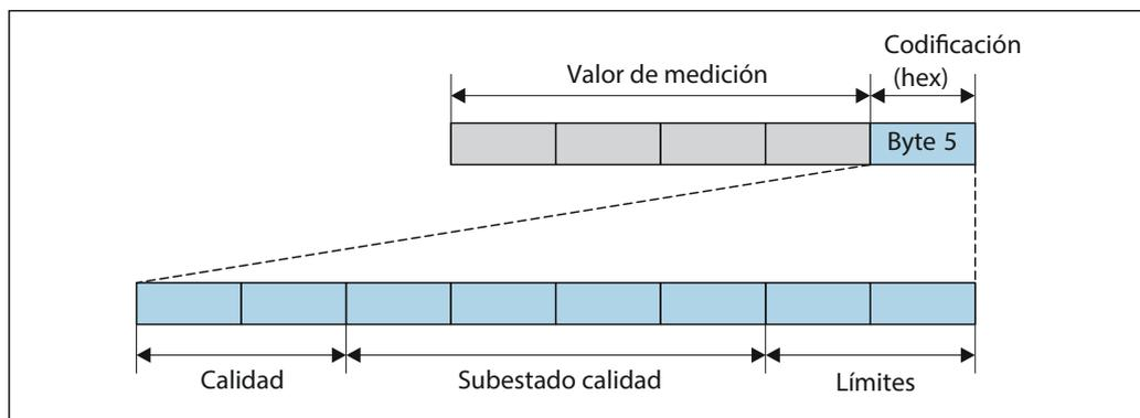
22 Estructura del byte de codificación
