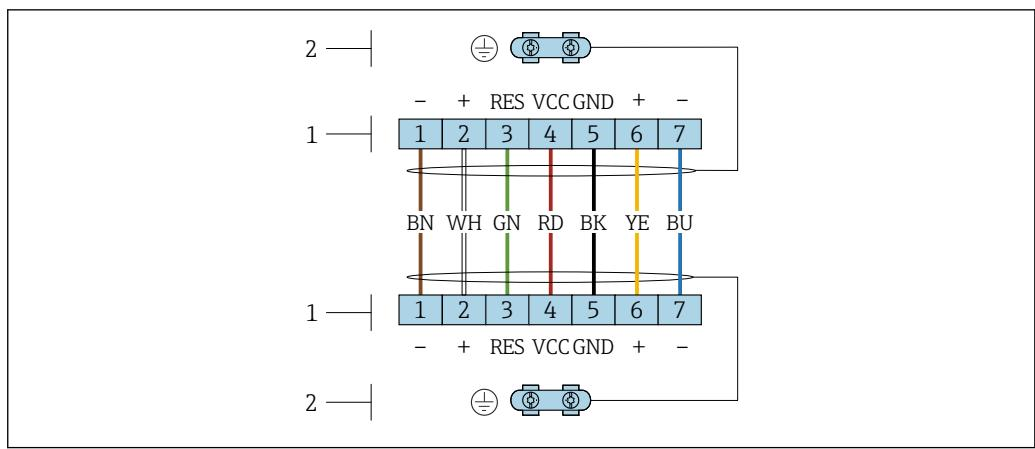
**■ 13 Bornes de raccordement pour le compartiment de raccordement dans le support mural du transmetteur et le boîtier de raccordement du capteur**
