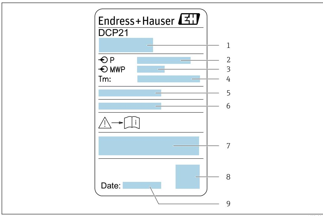
Fig. 6 Exemple d'une plaque signalétique de cellule de mesure de pression
