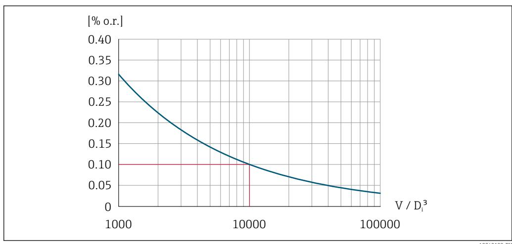
22 Повторяемость – 0,1 % ИЗМ при измерении объемного расхода ( $\text{м}^3$ ) от  $V = 10000 \cdot D_i^3$
