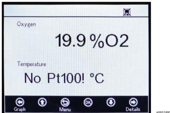
Figura 27. Messaggio di errore per sensore di temperatura
