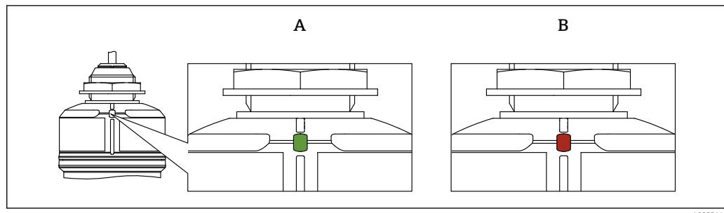
图 11 设备上的 LED 指示灯
