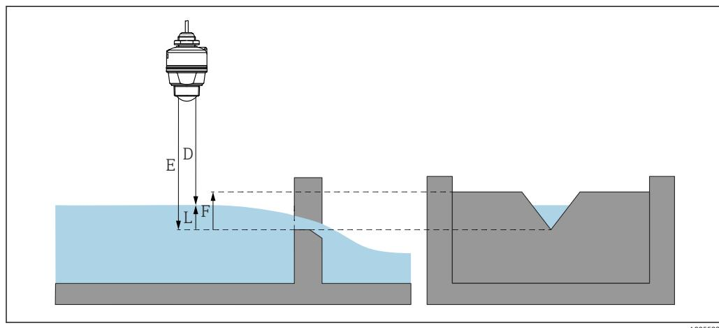
图 18 实例：V 形槽口测量堰
