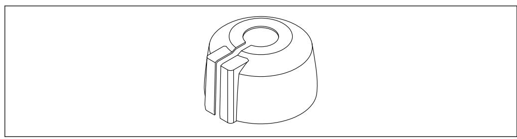
图 4 防护罩, 顶部电缆入口
