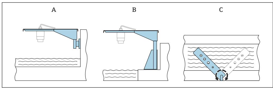
图 8 使用悬臂安装 (可旋转)
