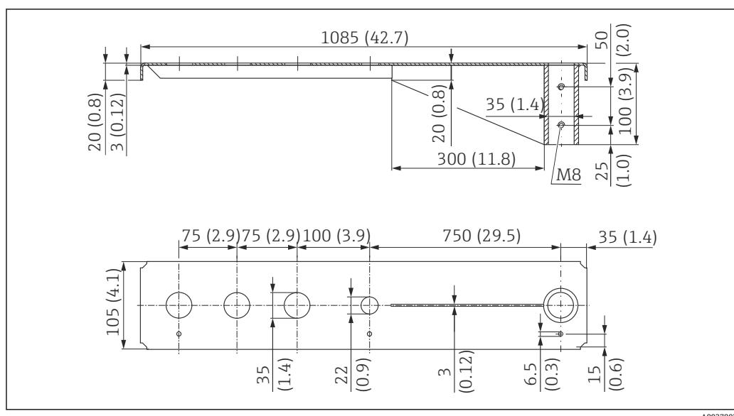
图 33 1000 mm 旋转悬臂的外形尺寸 (安装在传感器电缆入口过程连接上)。测量单位 mm (in)
