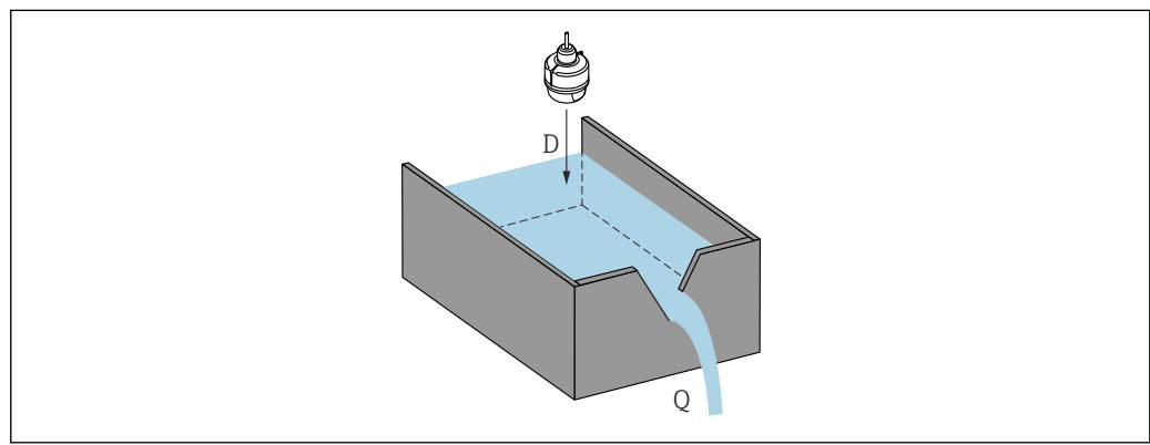
图 16 液体流量测量的设置参数
