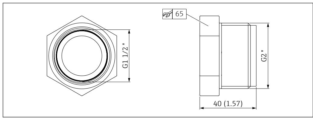
图 23 UNI 转接头的外形尺寸
