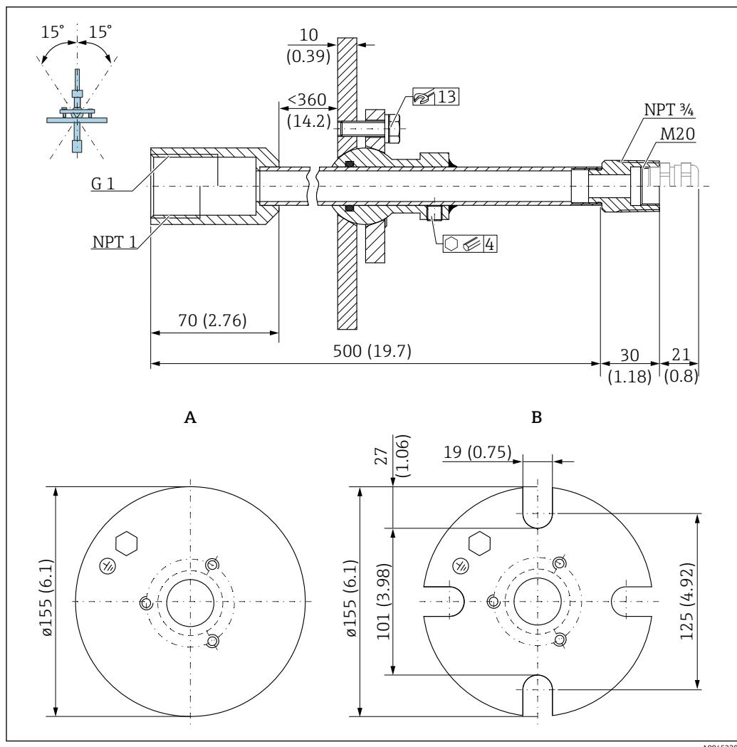
图 41 外形尺寸。测量单位 mm (in)
