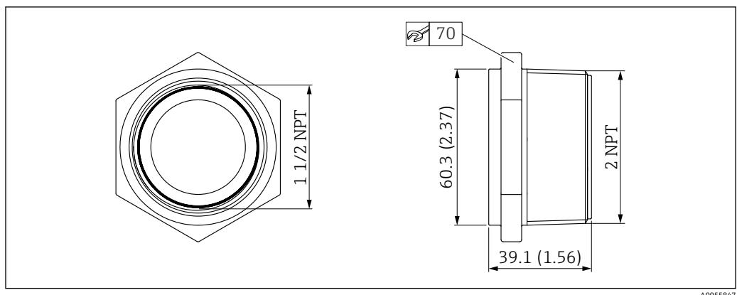
图 24 UNI 转接头的外形尺寸
