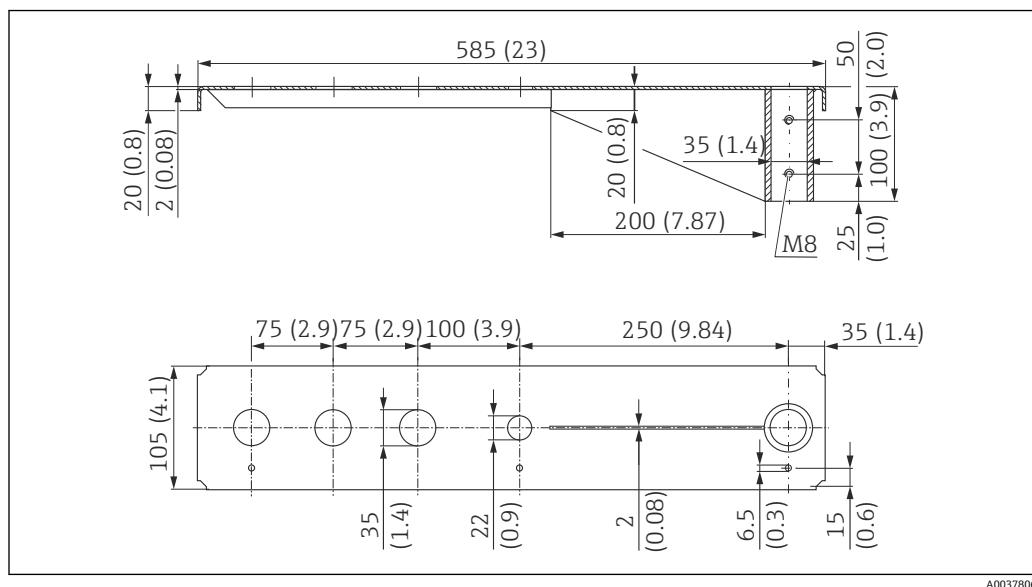
图 32 500 mm 旋转悬臂的外形尺寸 (安装在传感器电缆入口过程连接上)。测量单位 mm (in)
