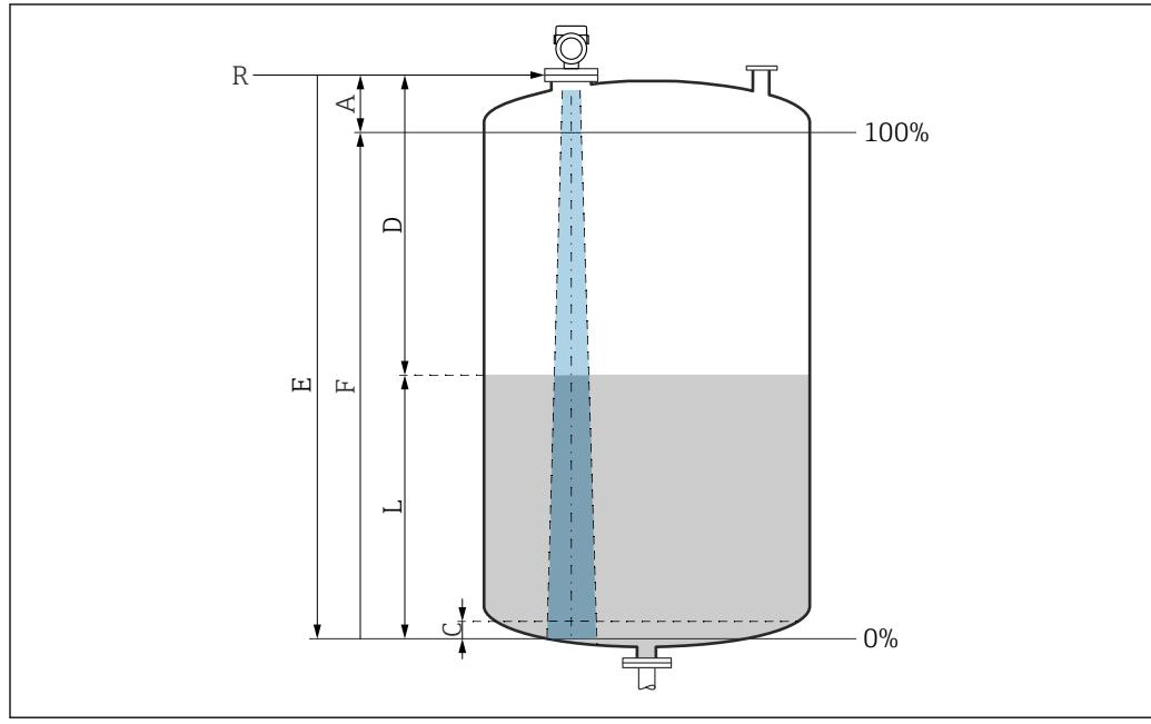
图 14 液位测量的设置参数
