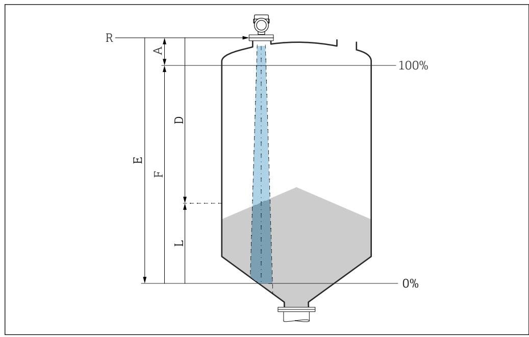
图 15 固体散料料位测量的设置参数
