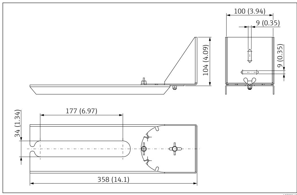
图 40 旋转安装架的外形尺寸。测量单位 mm (in)
