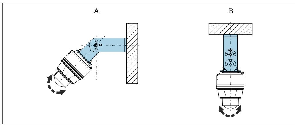
图 6 使用安装架安装 (可调节)
