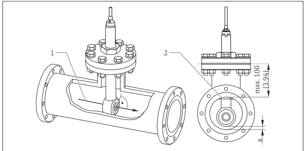
5 Orientação do sensor, dimensões em mm (pol.)
