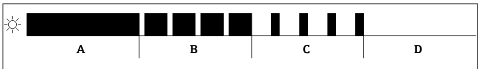
■ 4 Affichage graphique de différents états clignotants des LED lorsqu'une fonction est sélectionnée
