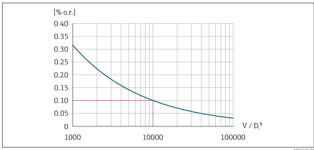
22 Повторяемость – 0,1 % ИЗМ при измерении объемного расхода ( $m^3$ ) от  $V = 10000 \cdot D_i^3$
