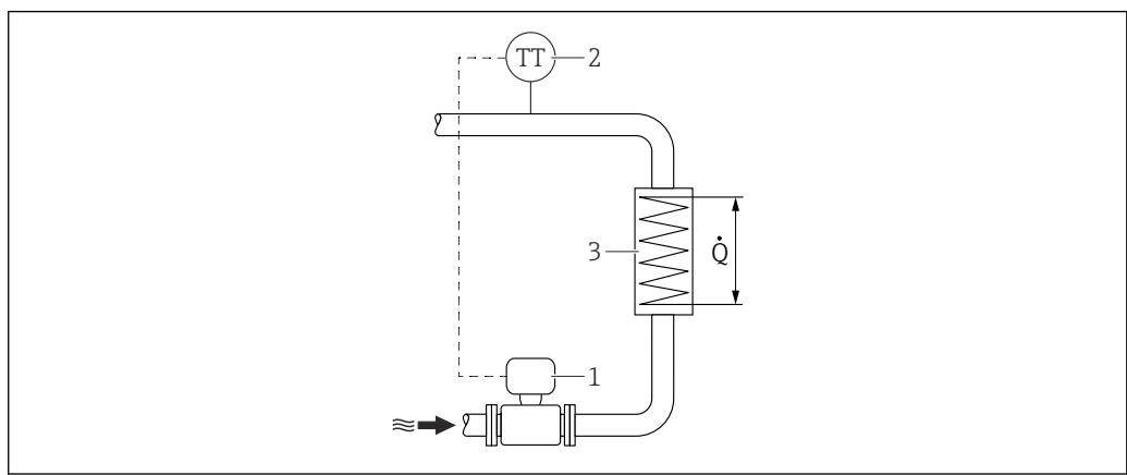
5 Схема измерения изменения количества теплоты для насыщенного пара и воды
