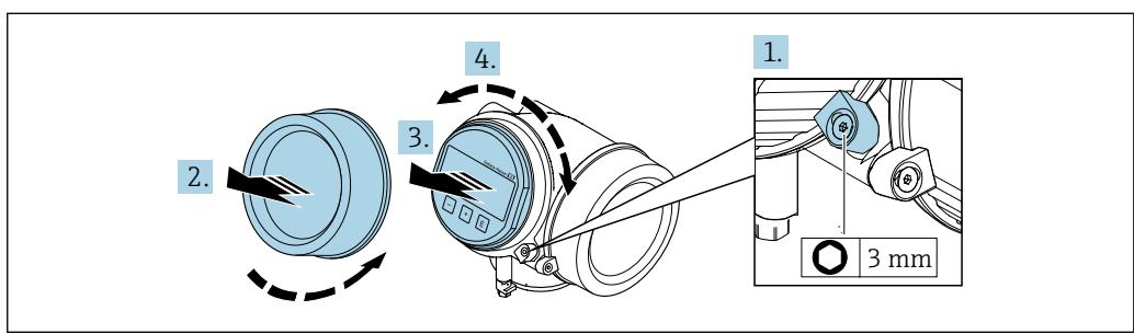
1. Ослабьте фиксирующий зажим крышки отсека электронного модуля с помощью шестигранного ключа.
