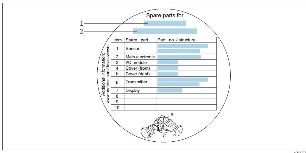
■ 21 Пример ярлыка с обзором запасных частей на крышке клеммного отсека
