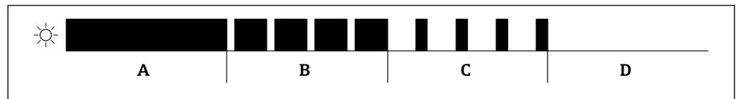
4 Grafische Darstellung für unterschiedliches Blinkverhalten der LEDs bei der Funktionsauswahl
