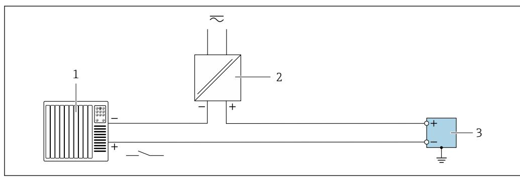
■ 8 Пример подключения для входного сигнала состояния
