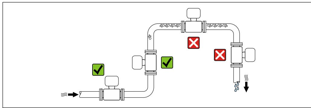
Во избежание ошибок при проведении измерений, вызванных образованием пузырьков газа в измерительной трубке, не устанавливайте прибор в следующих местах в меню::
