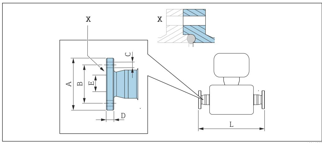
35 Выноска X: асимметричное технологическое соединение; деталь, выделенная синим цветом, предоставляется поставщиком.
