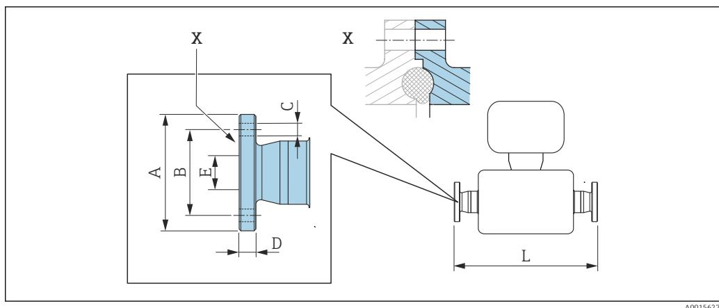
■ 33 Выноска X: асимметричное технологическое соединение; деталь, выделенная синим цветом, предоставляется поставщиком.
