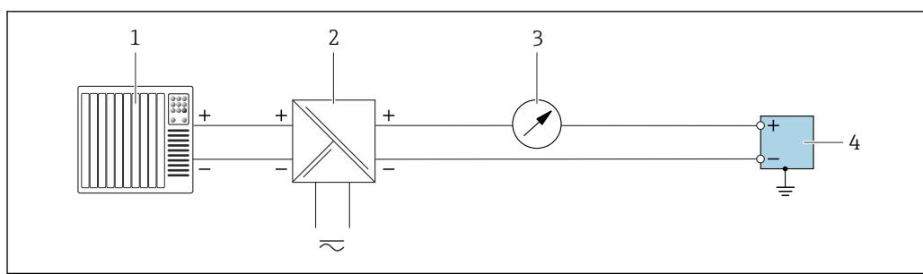
**3** Пример подключения для токового выхода 4 до 20 mA (пассивного)
