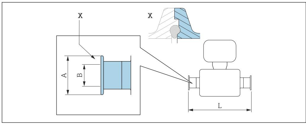
37 Выноска X: асимметричное технологическое соединение; деталь, выделенная синим цветом, предоставляется поставщиком.
