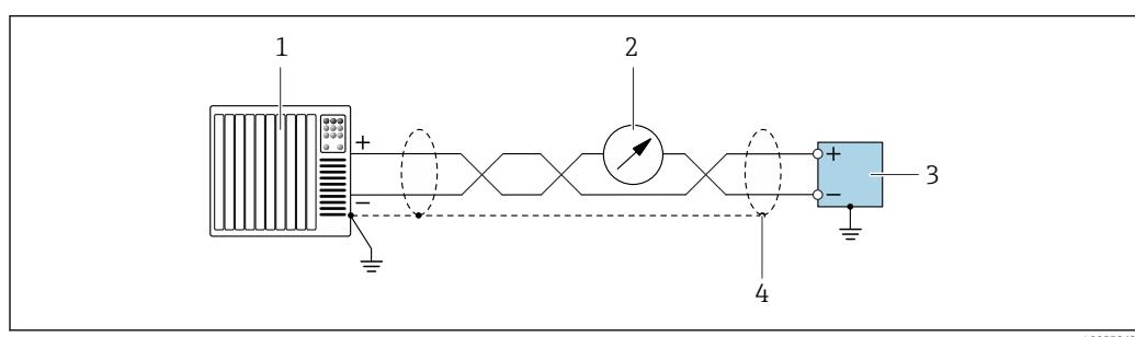
■ 9 Пример подключения для токового выхода 4 до 20 мА (активного) с HART
