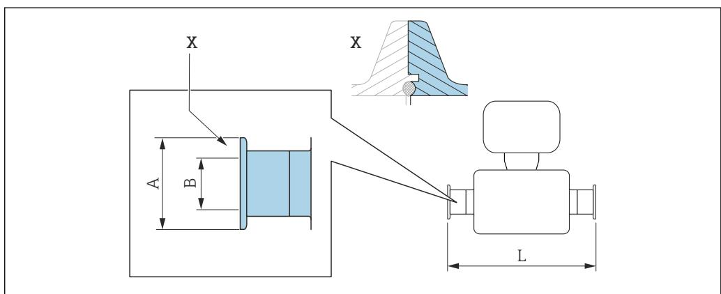
38 Выноска X: асимметричное технологическое соединение; деталь, выделенная синим цветом, предоставляется поставщиком.
