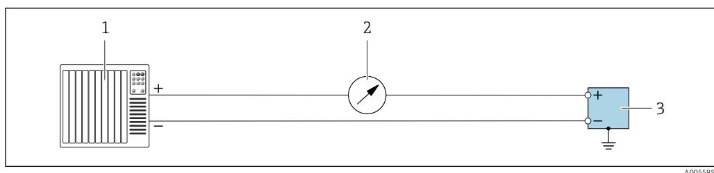
**2** Пример подключения для токового выхода 4 до 20 mA (активного)
