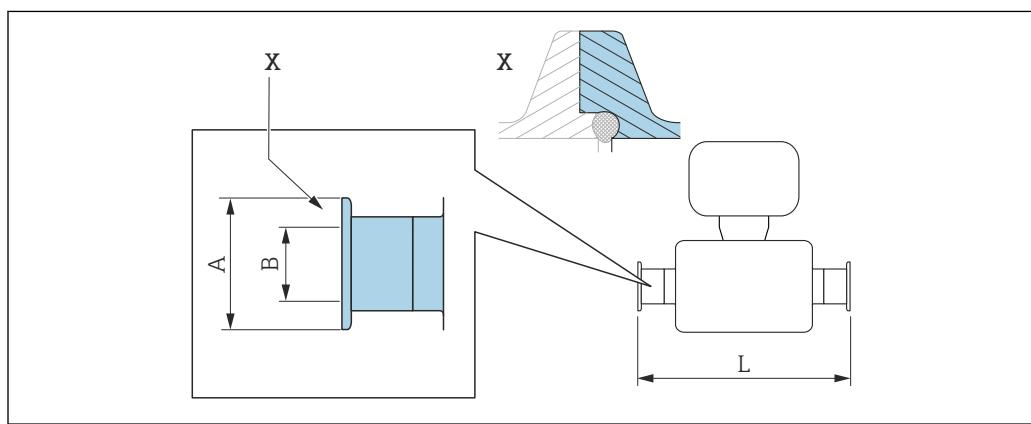
■ 39 Выноска X: асимметричное технологическое соединение; деталь, выделенная синим цветом, предоставляется поставщиком.
