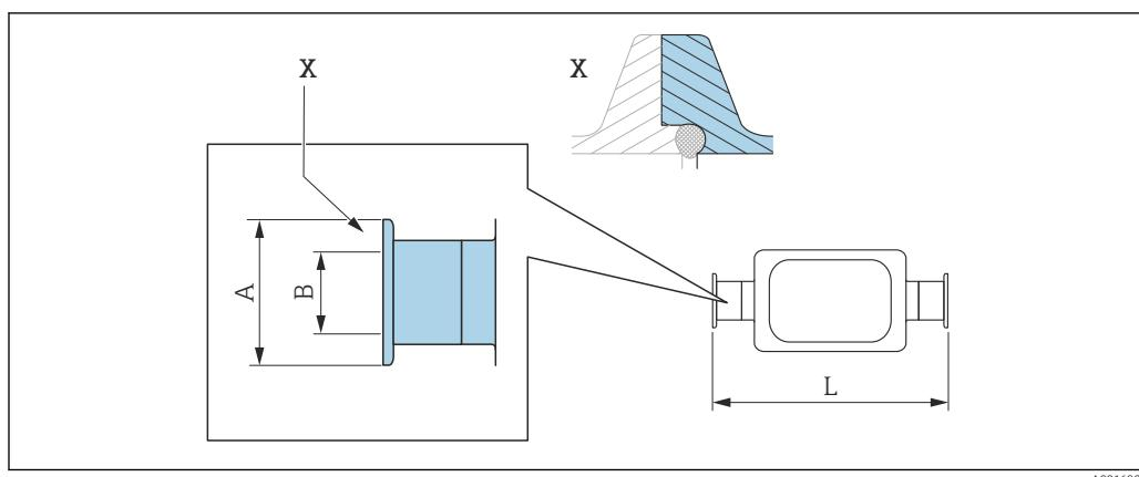
■ 42 Выноска X: асимметричное технологическое соединение; деталь, выделенная синим цветом, предоставляется поставщиком.
