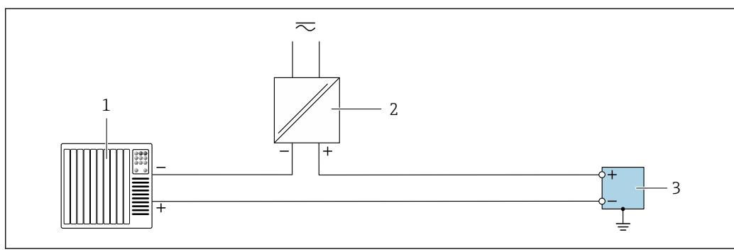
■ 6 Пример подключения для импульсного/частотного/релейного выхода (пассивного)
