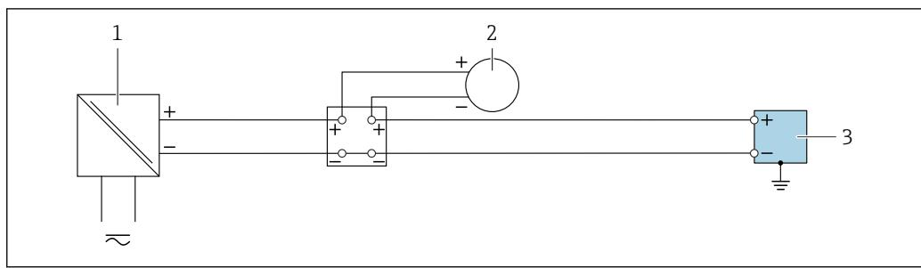
■ 4 Пример подключения для токового входа 4 до 20 mA
