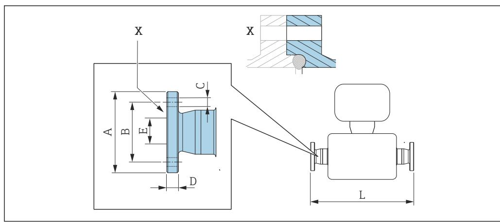
50 Выноска X: асимметричное технологическое соединение; деталь, выделенная синим цветом, предоставляется поставщиком.
