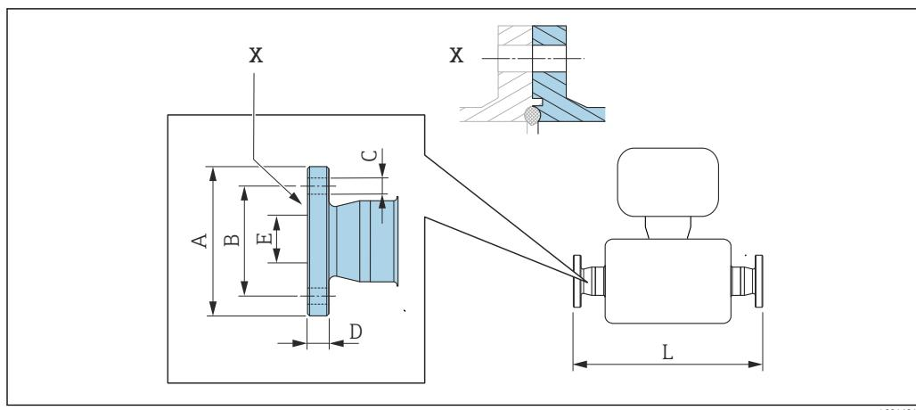
■ 34 Выноска X: асимметричное технологическое соединение; деталь, выделенная синим цветом, предоставляется поставщиком.
