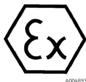
Figura 3. Etiqueta ATEX para uso en áreas de peligro
