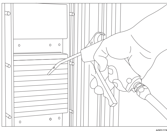
Figure 46. Nettoyage des dissipateurs thermiques avec de l'air comprimé ou de l'eau
