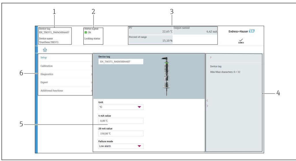
図 7 機器情報のユーザーインターフェース (HART® 通信経由)
