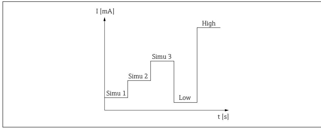
図 14 電流ループテスト曲線
