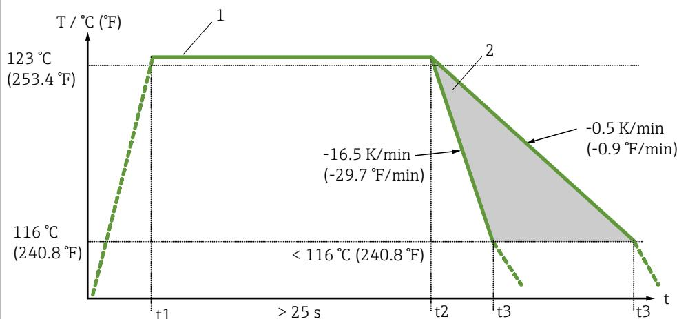
図 10 自己校正に必要なプロセス温度プロファイル
