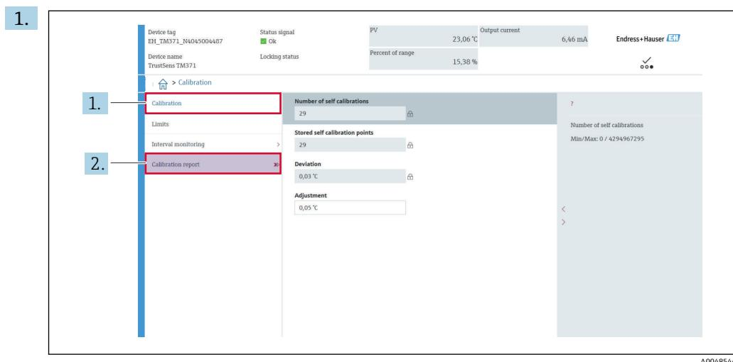
**Calibration** を押して、校正メニューに移動します。
