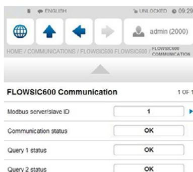
Abb. 29: Menüpunkt „Communication/Flowsic600-XT Flow Meter/FLOWSIC600-XT Communication“
