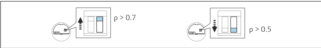
图 56 电子插件上的密度设置开关
