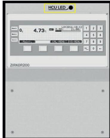
In der Frontplatte befindet sich eine Öffnung, die mit „HCU LED“ bezeichnet ist. Durch diese Öffnung ist die Sicht auf die Fehler-LEDs möglich. Bei Auftreten einer Störung muss die Elektronik zurückgesetzt werden. Dieses geschieht durch Ausschalten und Wiedereinschalten des Systems.
