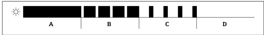
5 Grafische Darstellung für unterschiedliches Blinkverhalten der LEDs bei der Funktionsauswahl
