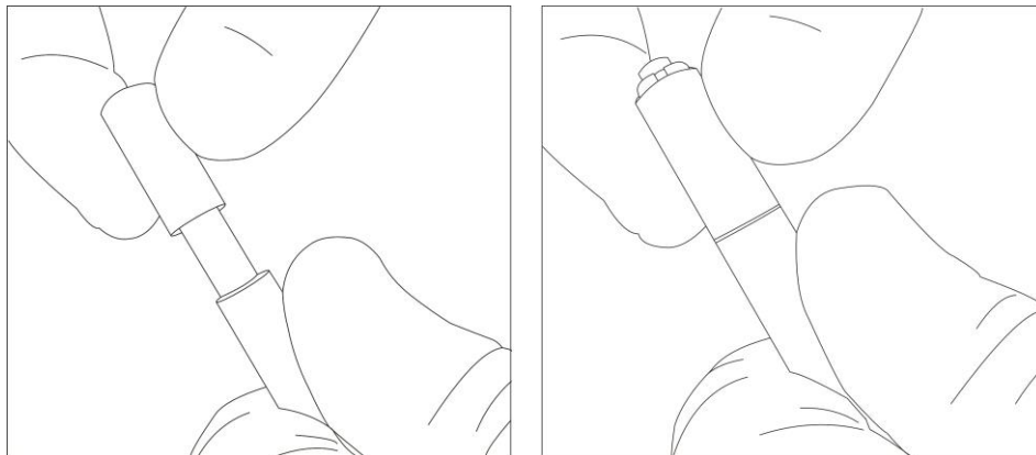
图 28. 在生物工艺用套管干燥器中安装干燥剂
